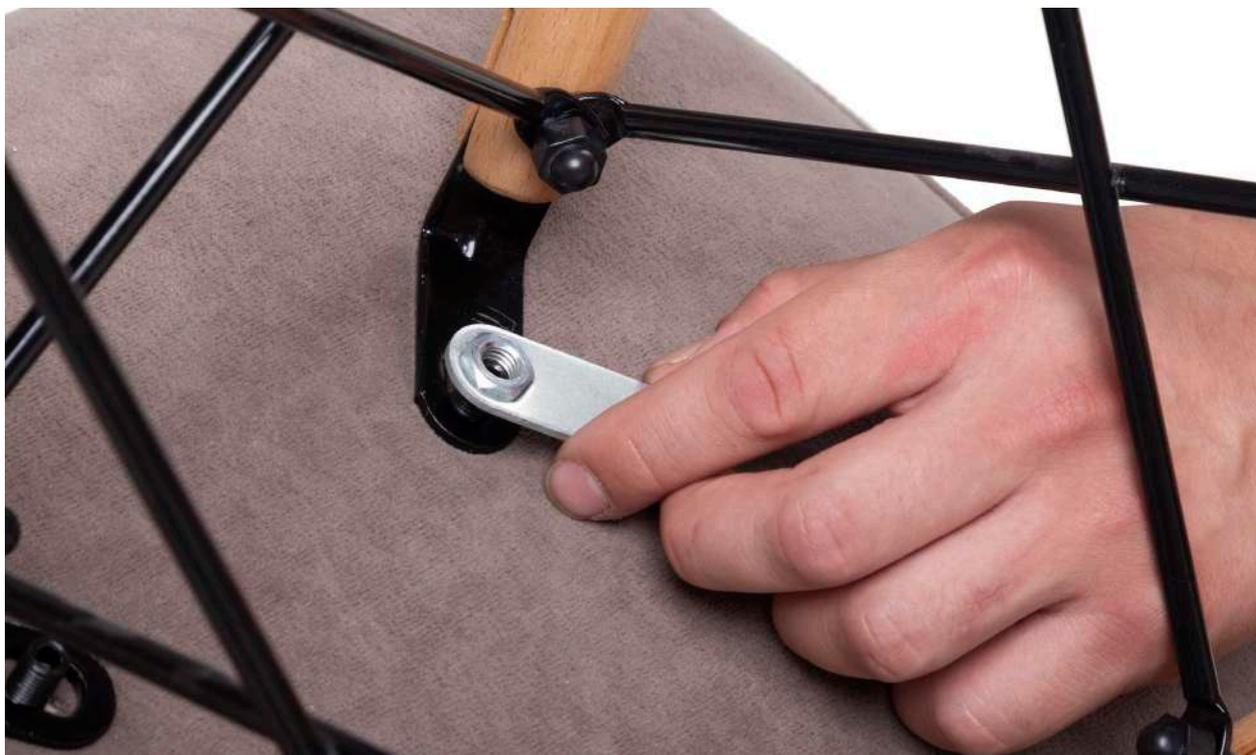
Шаг 9. Вкрутите гайку M8 (F0204) на винт DIN 913 (F0201)
