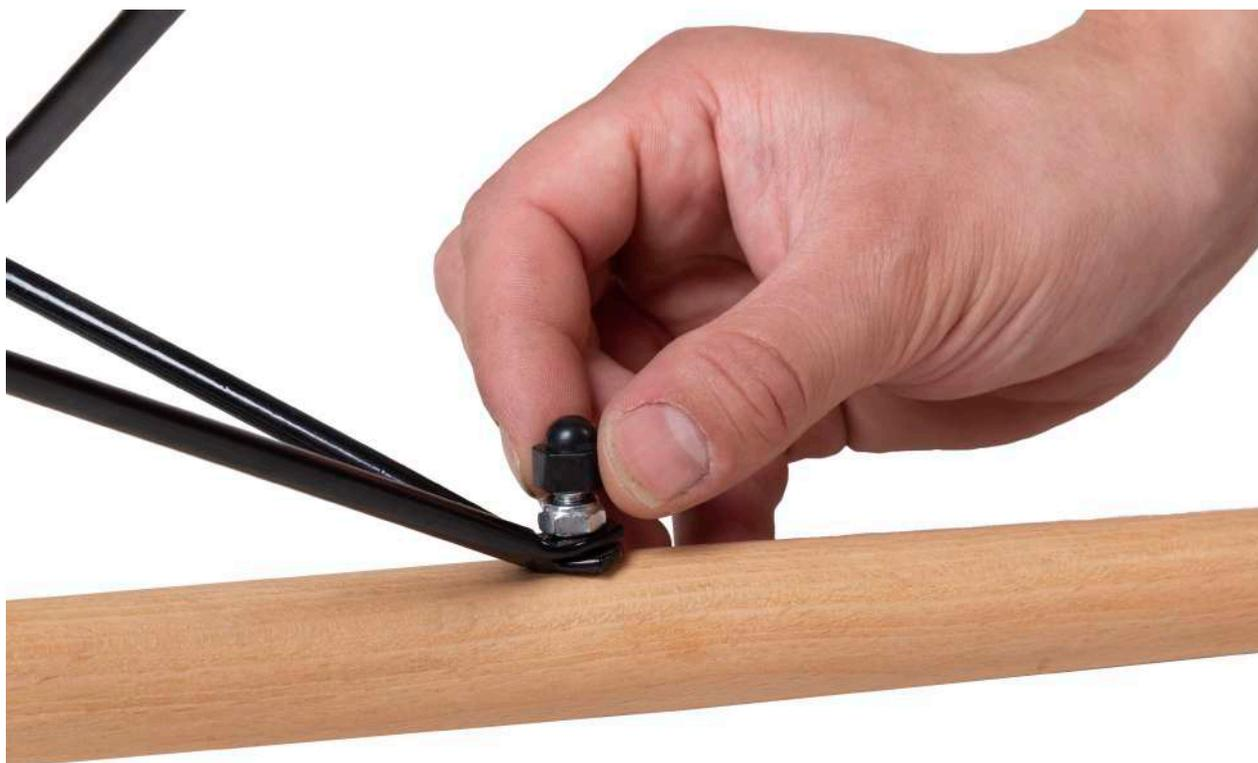
Шаг 6. Установите заглушки M6 (F0203) поверх гайки M6 (F0202)
